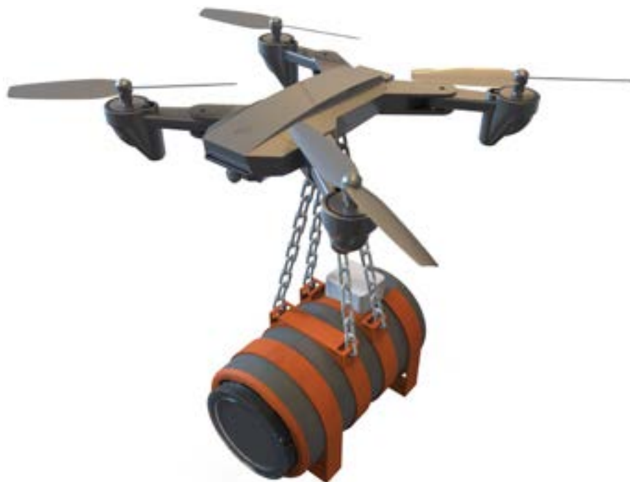
↑ Representación tridimensional de sistema de muestreo microbiológico suspendido desde vehículo aéreo no tripulado. Fuente: Alejandro Durán
